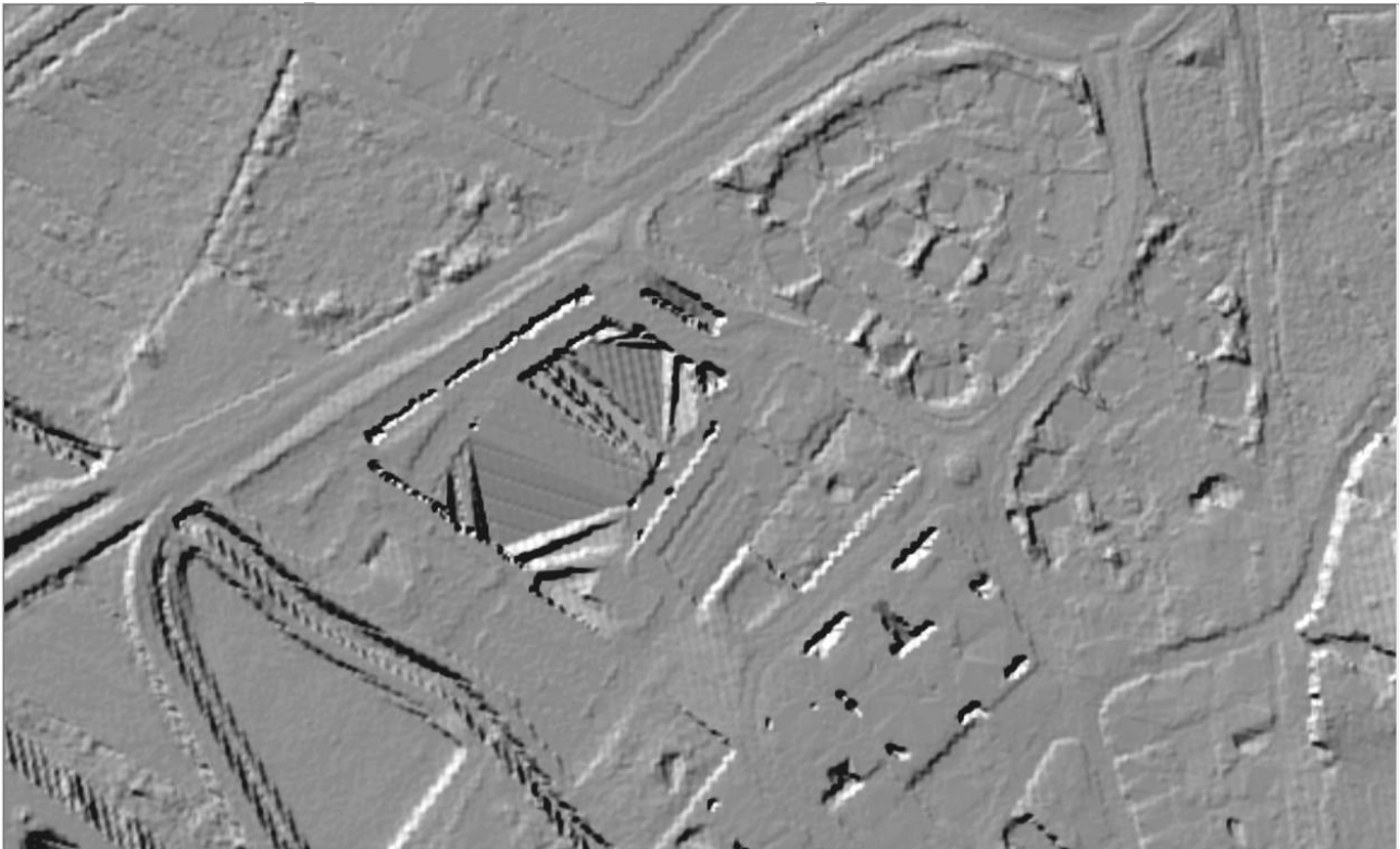
Figura 7-1 - Esempio di aberrazione del modello digitale del terreno in corrispondenza di un volume edificato.
