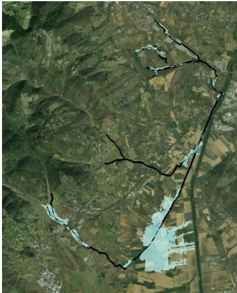
Figura 4-52 Esondazioni massime per Tr=30 anni
