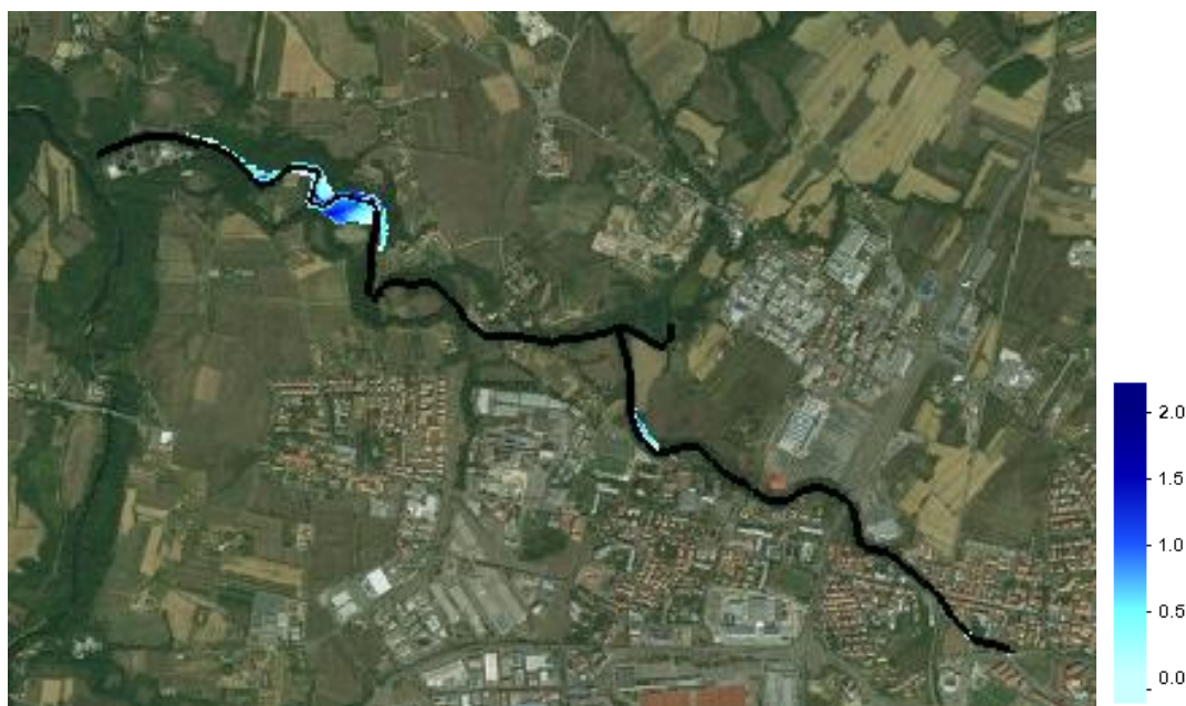
Figura 4-92 Esondazioni massime per la parte di valle del reticolo del Torrente Castro T_r=30 anni
