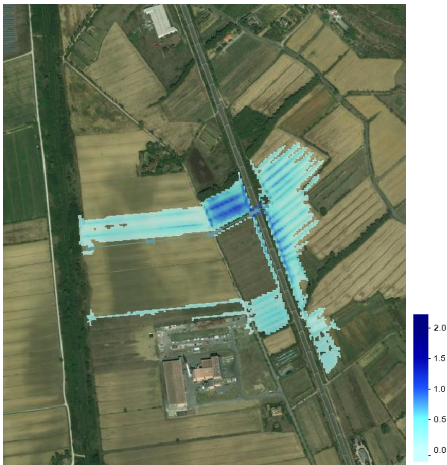
Figura 4-28 Aree allagate per Tr200 anni dovute al fosso posto a nord dell’impianto AISA
