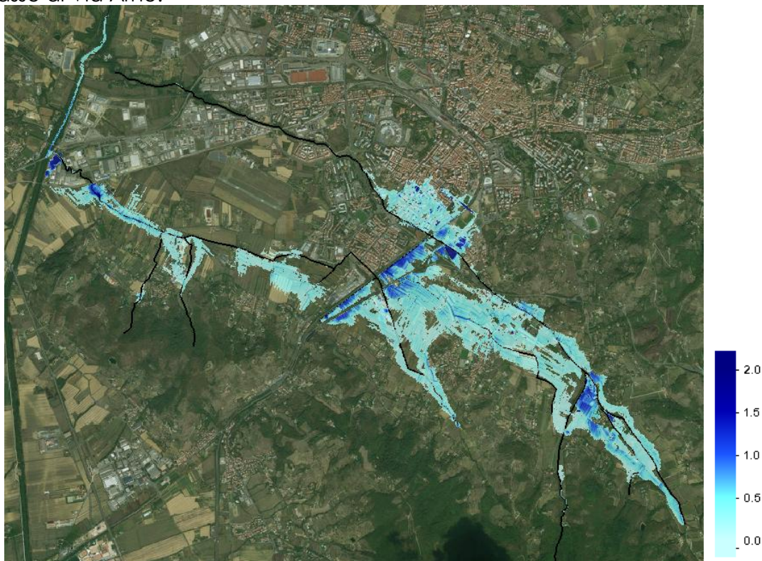
Figura 4-100 Esondazioni massime per l'intero reticolo T_r=200 anni
