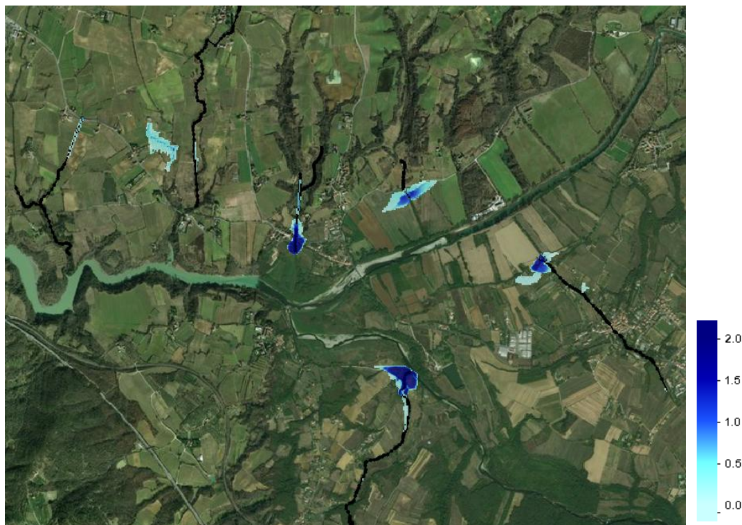
Figura 4-37 Esondazioni per T_r=200 anni a t=1h
