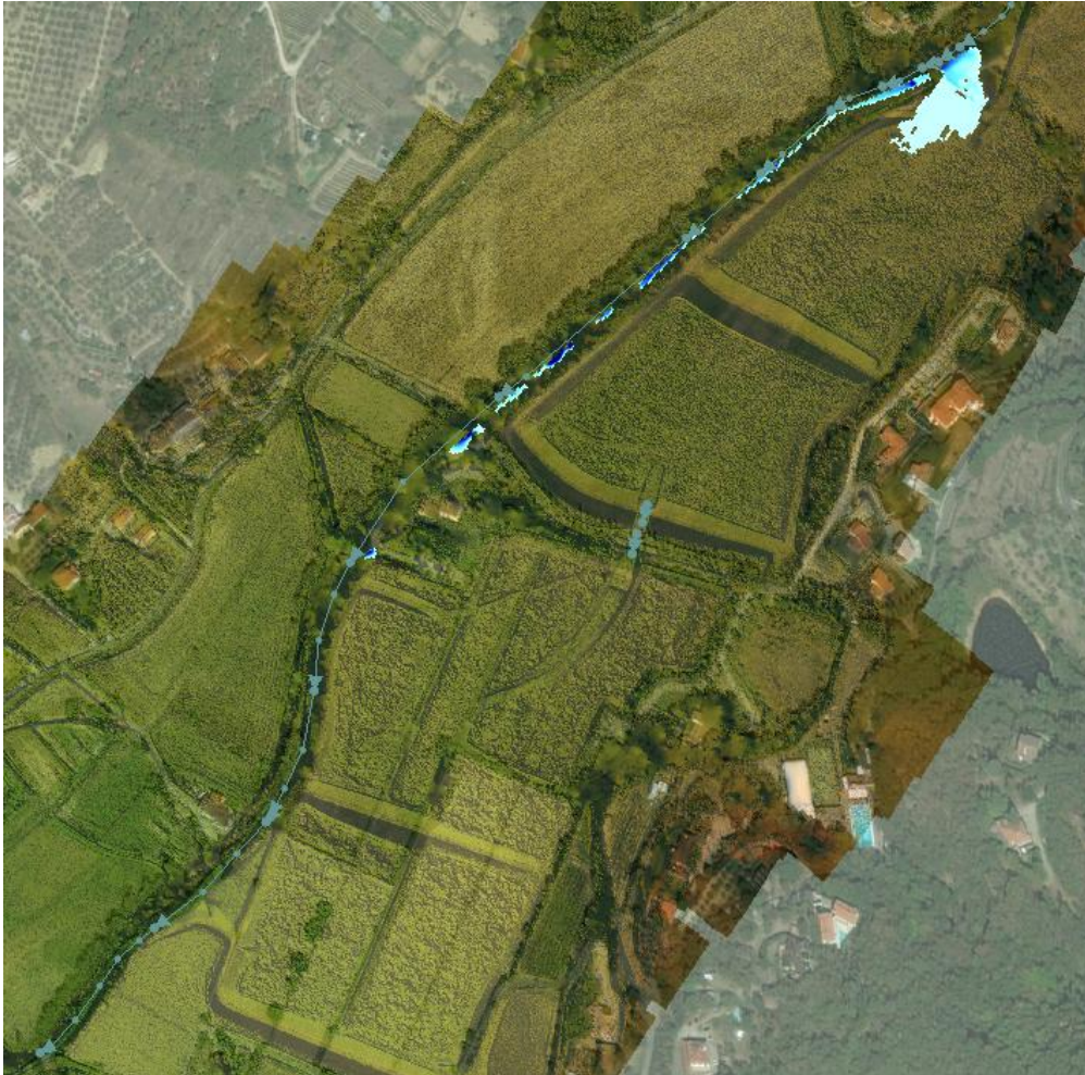
Figura 4-70 Andamento delle esondazioni per T_r=200 anni a t=1h
