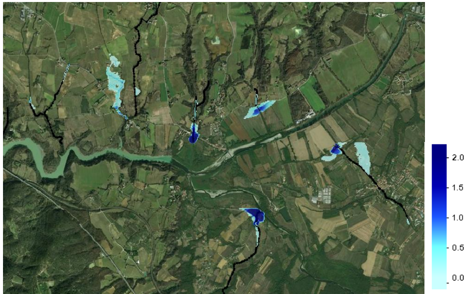
Figura 4-38 Esondazioni per T_r=200 anni a t=2h
