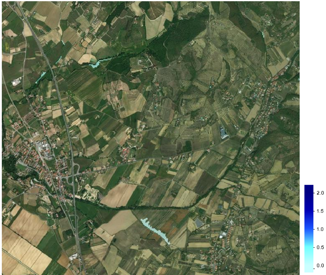
Figura 4-45 Esondazioni per Tr=200 anni a t=1h
