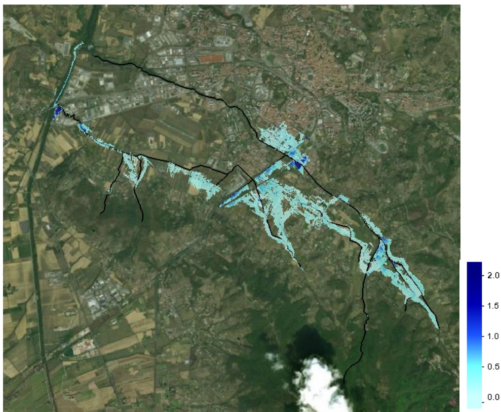
Figura 4-101 Esondazioni massime per l'intero reticolo Tr=30 anni
