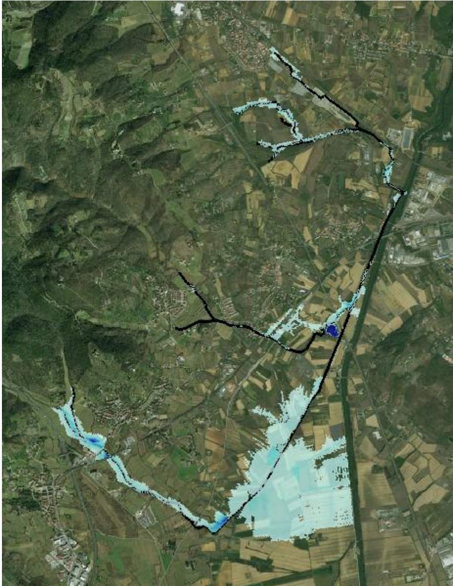
Figura 4-51 Esondazioni massime per Tr=200 anni
