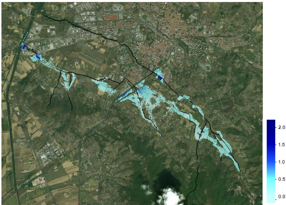
Figura 4-99 Esondazioni per l'intero reticolo T_r=200 anni a t=2h
