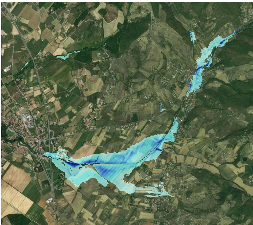
Figura 4-48 Esondazioni massime per Tr=30 anni
