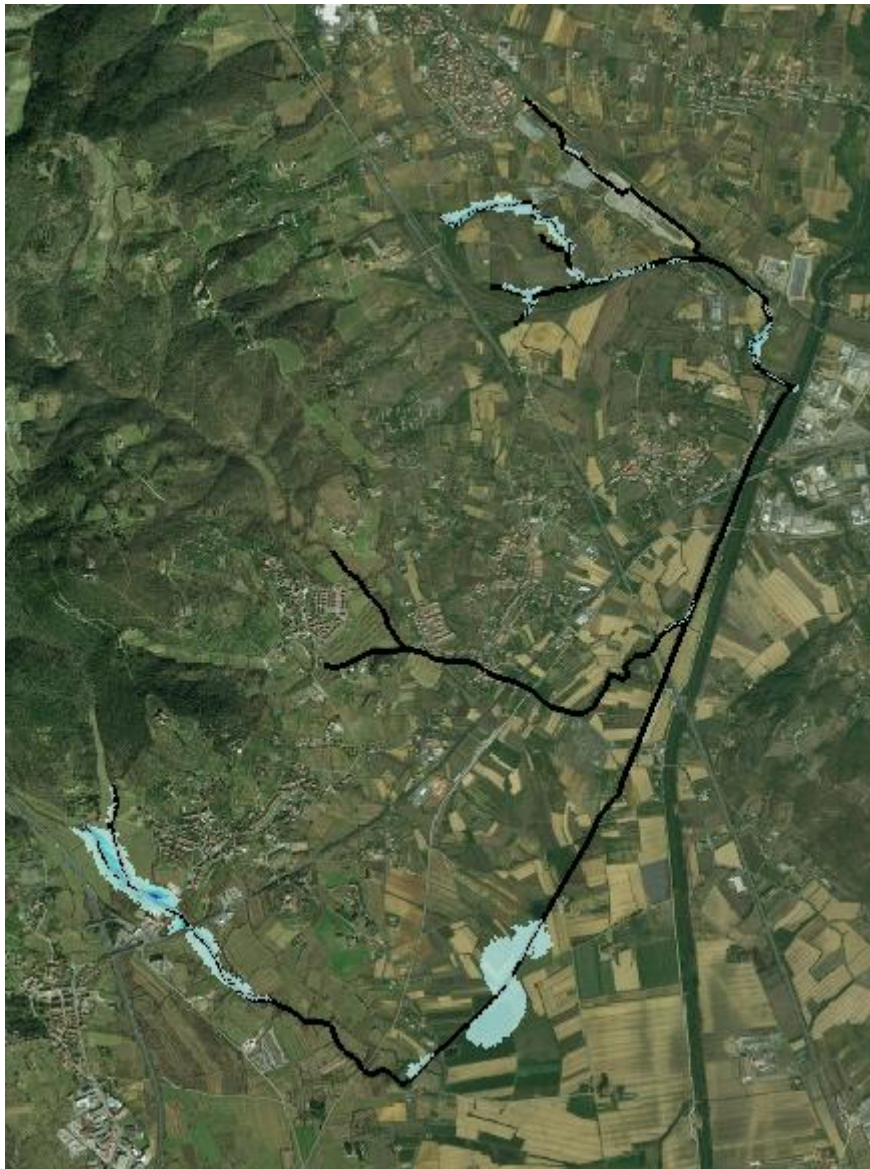
Figura 4-50 Esondazioni per Tr=200 anni a t=1h
