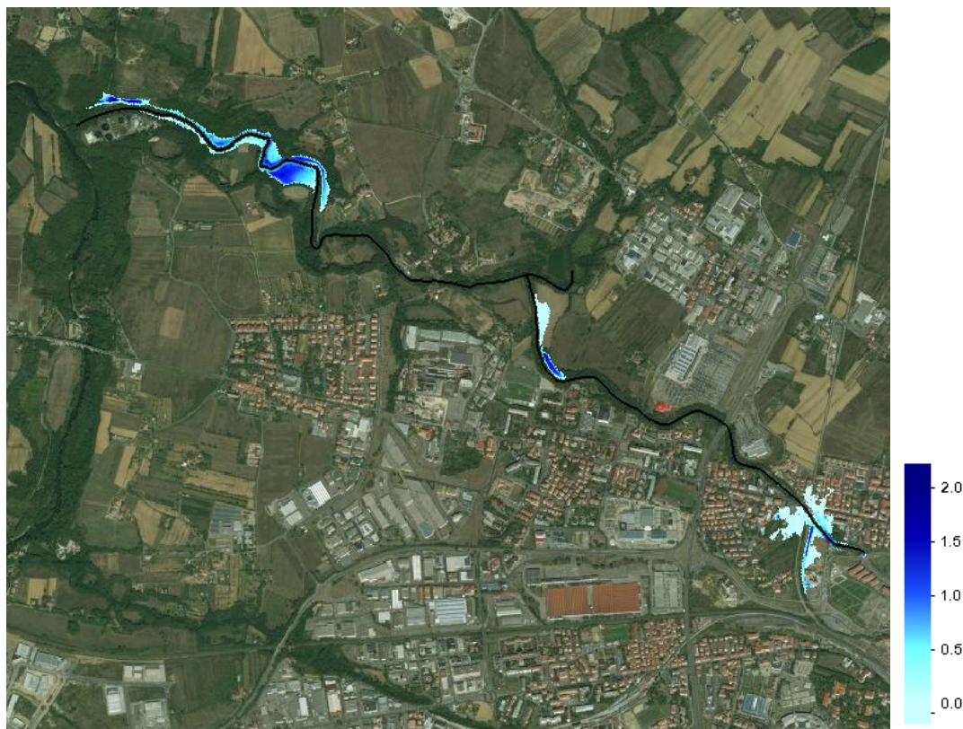
Figura 4-91 Esondazioni massime per la parte di valle del reticolo del Torrente Castro T_r=200 anni
